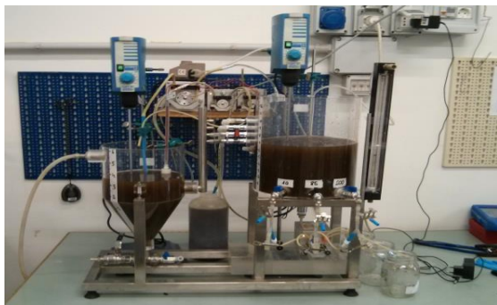
Sperimentazione processo DyMANOx per rimozione N da percolato di discarica
