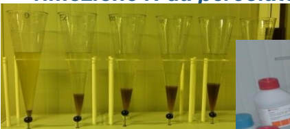
Sperimentazione processo DyMANOx per rimozione N da percolato di discarica
